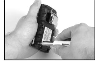
À l'aide d'un tournevis Torx, serrez chacune des quatre vis pour fixer la batterie (représentée) ou le couvercle de la batterie à l'instrument.
