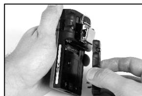
Soulevez la batterie (gauche) ou le couvercle de batterie et la batterie longue durée (droite) et sortez-la de l'instrument.
