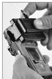
Retirez la coupelle d'étalonnage : soulevez par les languettes de la coupelle.
