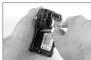
À l'aide d'un tournevis Torx, desserrez les quatre vis de la batterie (gauche) ou du couvercle de la batterie (droite).
