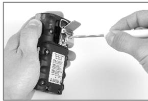
Pour retirer le clip, utilisez un tournevis Torx pour accéder à la vis du clip. Tournez dans le sens inverse des aiguilles d'une montre pour desserrer la vis.
