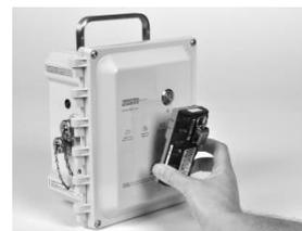
Pour établir une connexion entre un instrument Ventis Pro Series et une passerelle RGX, tenez le haut-parleur du Ventis Pro contre le logo de la passerelle RGX pendant cinq secondes ou jusqu'à ce que l'instrument émette une tonalité ascendante qui indique la connexion.
