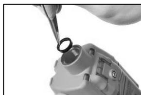
Placez le nouveau filtre hydrophobe à l'intérieur du cylindre d'aspiration, le côté ayant la plus grande surface de filtrage faisant face à l'utilisateur.
