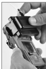
Inspectez visuellement la coupelle d'étalonnage pour vous assurer que ses bords le long du haut et des côtés sont alignés avec les bords du boîtier de l'instrument.
