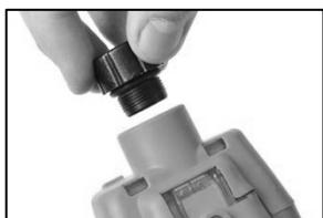
Pour dévisser et retirer le couvercle de la pompe, tournez dans le sens inverse des aiguilles d'une montre.
