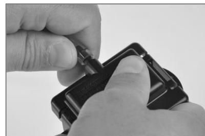
Connectez l'autre extrémité du tube à la coupelle d'étalonnage.
