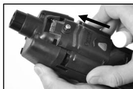
Abaissez le volet de la pompe. Faites-le glisser dans sa position fermée et encliquetée.
