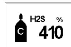
Le pourcentage de réserve de sensibilité est un indicateur de la durée de vie restante d'une cellule. Si cette valeur est inférieure à 50 %, la cellule ne réussira pas la procédure d'étalonnage.
