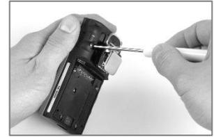
Serrez les deux vis du haut du boîtier à l'aide d'un tournevis Torx. Consultez le Tableau 8.1 pour les valeurs de couple.
