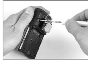
Desserrez les deux vis restantes du fond du boîtier à l'aide d'un tournevis Torx.
