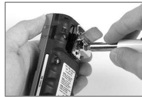
Pour attacher le clip, mettez la rondelle sur la vis et placez la vis dans le trou du milieu du clip.
