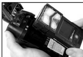
Placez l'instrument dans le boîtier de la pompe, puis serrez les quatre vis Torx à l'arrière de la pompe.
