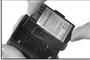
Pour installer la batterie longue durée, placez-la d'abord dans le couvercle de la batterie. Lorsqu'elle est placée correctement, l'étiquette de la batterie est visible.
