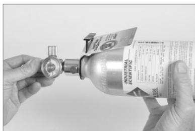
En tenant le détendeur, tournez la bouteille de gaz d'étalonnage dans le sens des aiguilles d'une montre pour serrer.
