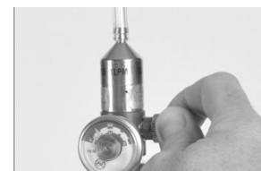
Arrêtez le débit de gaz : tournez le bouton du détendeur dans le sens des aiguilles d'une montre et serrez.
