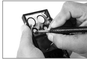
À l'intérieur de la partie supérieure du boîtier, attrapez le filtre hydrophobe de la cellule avec la pince à bec effilé. Décollez-le pour le retirer.
