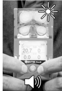
L'instrument vibrera et émettra ensuite un bip sonore. Vérifiez que les deux types de signaux fonctionnent.
