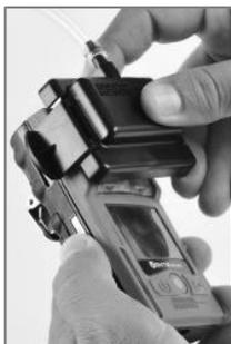
Inspectez visuellement la coupelle d'étalonnage pour vous assurer que ses bords le long du haut et des côtés sont alignés sur les bords du boîtier de l'instrument.
