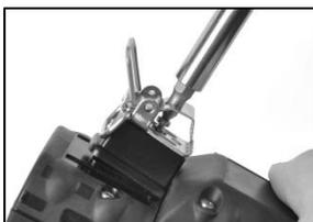
Pour retirer le clip, utilisez un tournevis Torx pour accéder à la vis du clip. Tournez dans le sens inverse des aiguilles d'une montre pour desserrer la vis.
